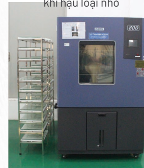
Buồng mô phỏng điều kiện khí hậu loại nhỏ
